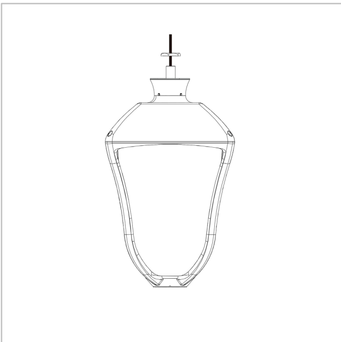
STYLAGE | Montage suspendu avec une fixation femelle de 1" ou 3/4" gaz
