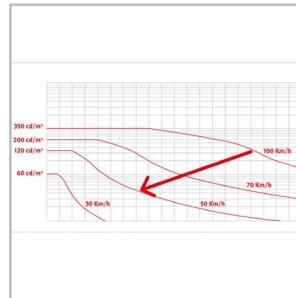
L'ATS 4 peut être associé à un système de mesure du trafic pour exploiter les données de vitesse ou de densité du trafic afin d'adapter le niveau d'éclairage conformément aux normes de sécurité. Cette option maximise les économies d'énergie et prolonge la durée de vie de l'installation tout en offrant les meilleures conditions de conduite aux automobilistes.
