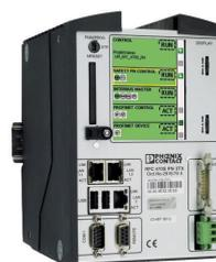
Mise au point conjointement par Schröder et Phoenix Contact, cette solution avancée a été conçue pour les tunnels stratégiques (tunnels autoroutiers ou à densité de trafic élevée) afin de contrôler chaque point d'éclairage ou groupe de luminaires. Cela permet d'assurer une parfaite adaptation de la luminosité aux conditions de roulage dans le tunnel, de surveiller la consommation d'énergie, ainsi que de consigner les heures de fonctionnement et de rapporter toute panne afin de faciliter la
