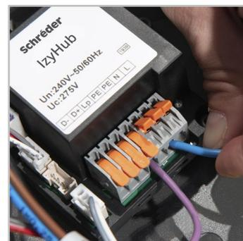
Le module IzyHub facilite la connexion électrique lors de l'installation et des opérations de maintenance.
